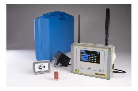
Il C6 EVO IoT RX contiene una scheda madre con un ricevitore di onde radio, un modulo GSM Globale, modulo WiFi e una batteria tampone d'emergenza blackout che consente una autonomia di 12 ore in assenza rete elettrica.
